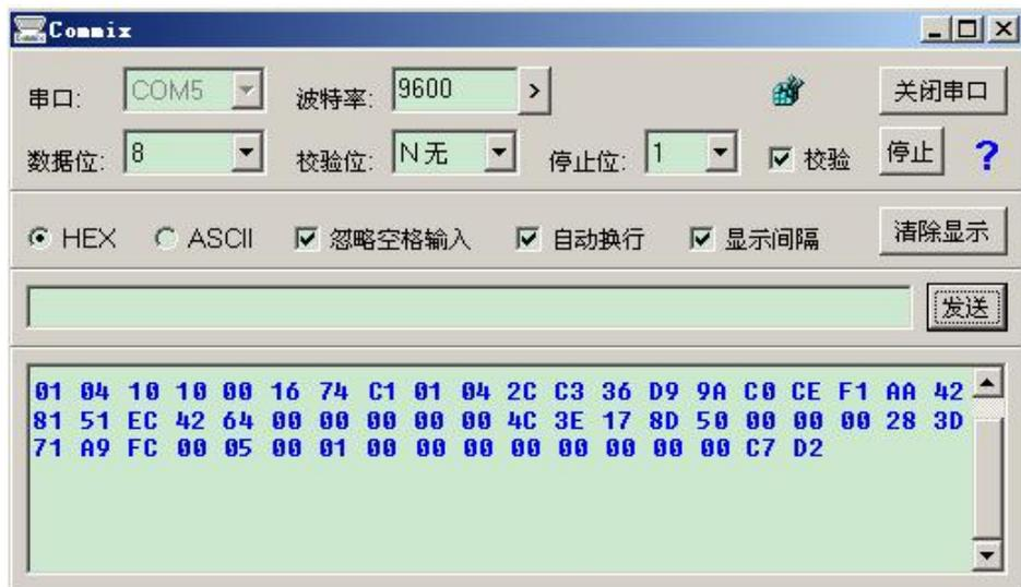
图 6-5 串口调试助手侦听示例图
