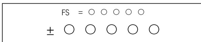
上行显示：FS 代表仪表零点测量值； 下行显示：流速零点设定值；
